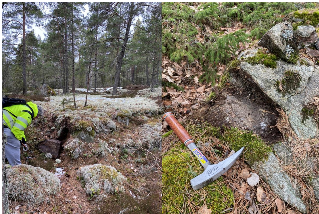
Figur 2-2 Exempel på geologi från området med flera större områden med berg i dagen och hållar med mycket tunt jordtäckte.
